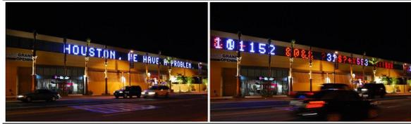
캘리포니아 노호(Noho) 빌딩에 설치된 73m 길이의 전광판. 통과 차량의 추적 정보로 조명 모드 조절. 기본 모드는 유명 대사를 10초 간격으로 보여주고, 교통량이 많아지면 하얀 색 글자가 차동차를 쫓는 방식으로 바뀌며, 서로 스쳐지나가는 자동차를 따라 빨간 색의 점으로 글자가 나타난다.
