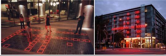
LA 다운타운 내 건물 멧 로프트(Met Lofts)의 파사드와 건물 입구 오픈 스페이스에 LED 타일. 건물 내부에 있는 사람들의 움직임은 건물의 파사드에 위치한 LED필드로도 동시에 전달되어 표현된다. 건물 로비의 LED와 연동되는 파사드의 LED필드를 통해 내부와 외부의 상호작용과, 소통을 유도한다.
