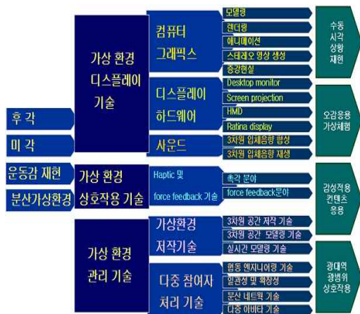
<그림 1> 가상현실 시뮬레이터의 기술 요소 (주)케이씨아이 제공
