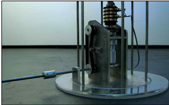
[그림 10] SoniColumn 본체의 하단부, 슬립링, 엔코더, 웜기어 세트가 조립된 모습
